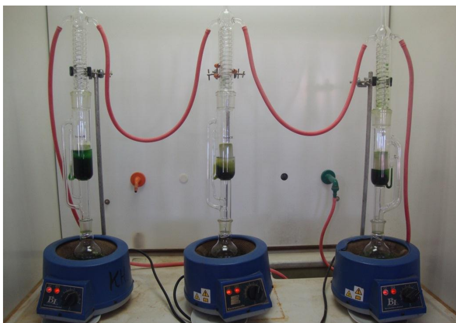
استخلاص النباتات باستخدام جهاز soxhlet
