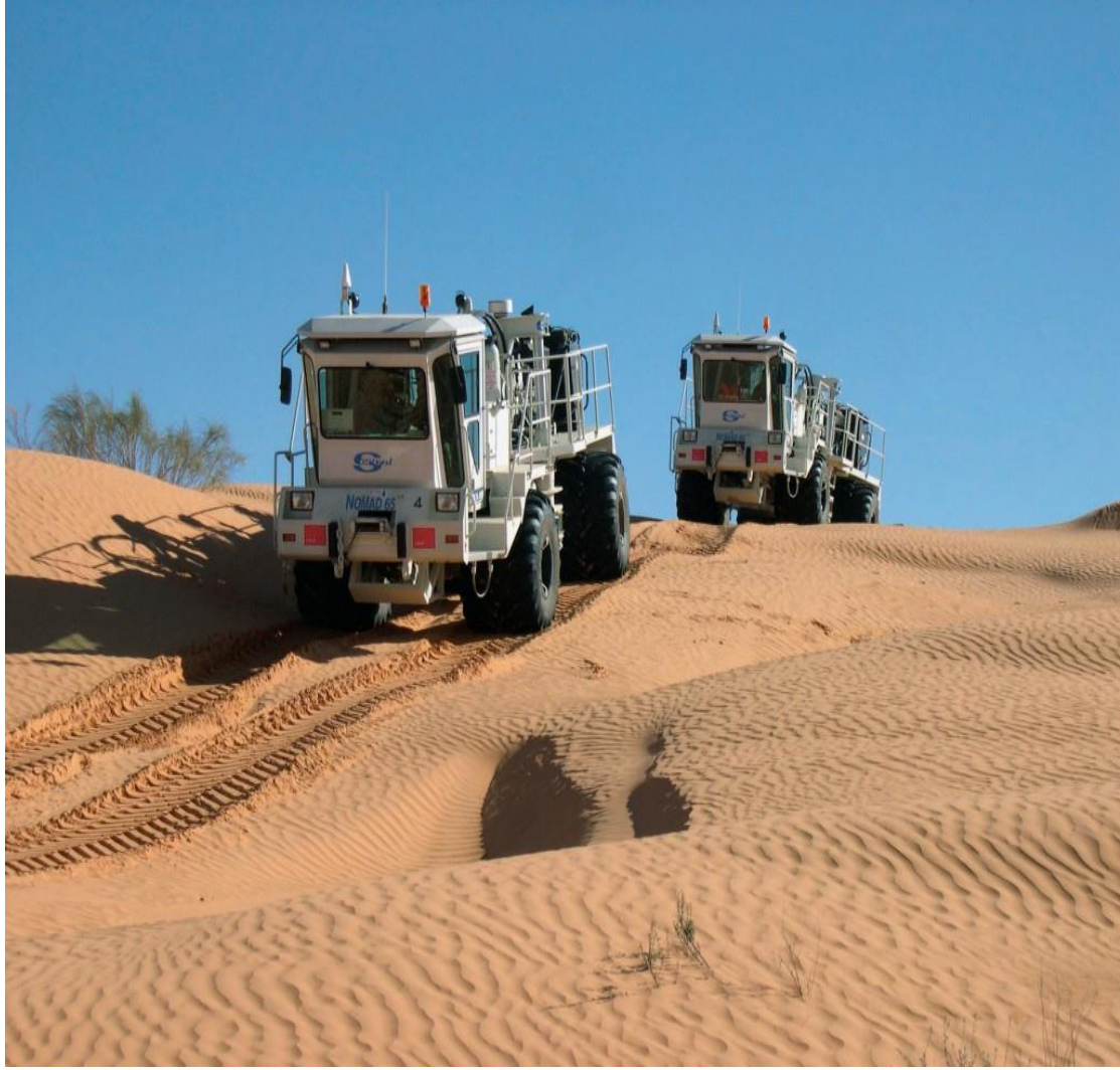
شكل (2-3) عربات الفيبروسس اثناء عملية المسح السيزمي.
