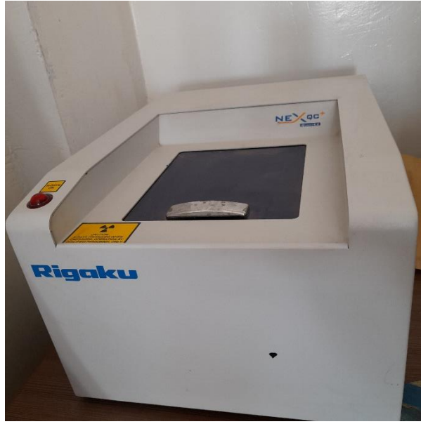
الشكل (2): جهاز فلورية الأشعة السينية المشتت للطاقة. الشركة المصنعة للجهاز هي شركة ريجاكو (Rigaku) موديل (NEX QC Quantize)
