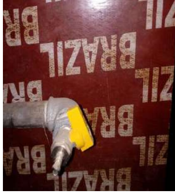
الشكل (14) الصنبور المستخدم في تركيبية تمرير الماء
