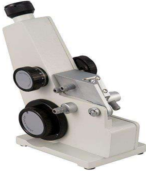
الشكل (7) يوضح جهاز أبي للانكسار .
