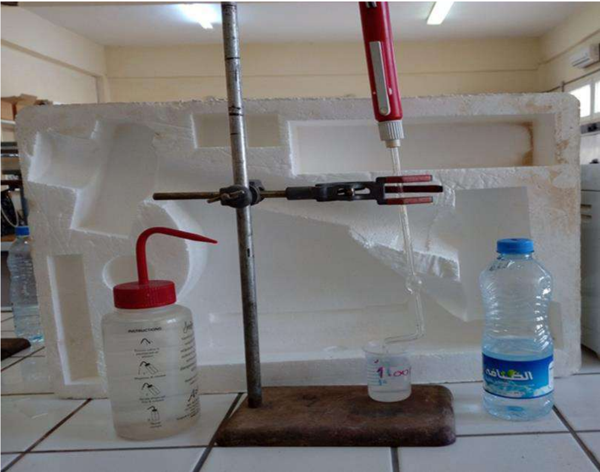
الشكل (3) يوضح تجربة الستلاجومتر.
