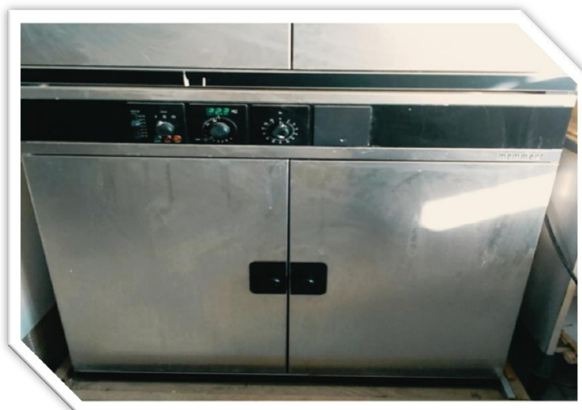
الشكل (7) يوضح الحاضنه تستخدم في توفير درجات الحرارة الملائمة لنمو الأحياء المجهرية على الأوساط الزراعية
