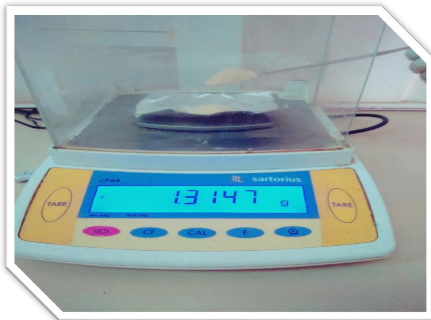
الشكل (10) يوضح الميزان الحساس (Delicate scales), يستعمل لوزن بعض البيئات أو المواد الكيميائية بدقة عالية
