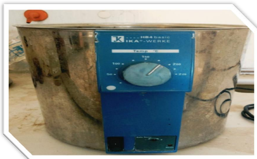
الشكل (11) يوضح حمام مائي (Water Bath). يضبط على درجات حرارية مختلف حسب الغرض المطلوب, ويستعمل في إذابة البينات الصلبة بعد تجمدها.
