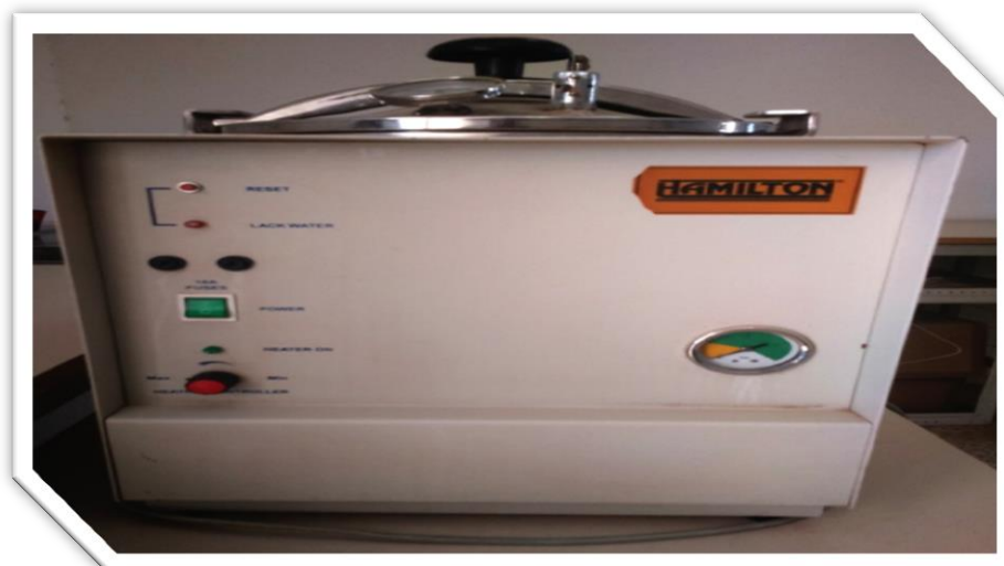
الشكل (12) يوضح جهاز التعقيم (Autoclave). يستعمل لقتل جميع الكائنات الحية الدقيقة في الأوساط والأدوات المراد تعقيمها.
