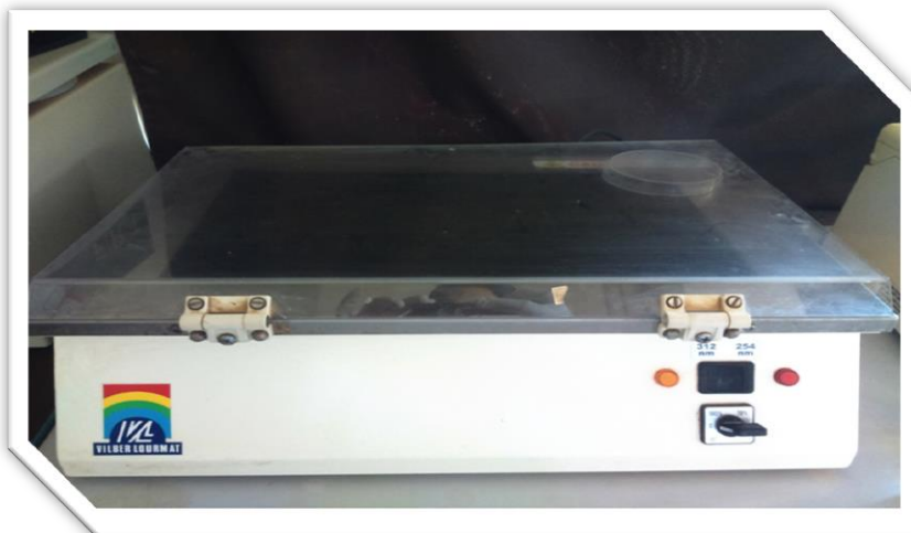
الشكل (5) يوضح جهاز الأشعة فوق بنفسجية يستخدم في كشف عن أحزمة الـ DNA
