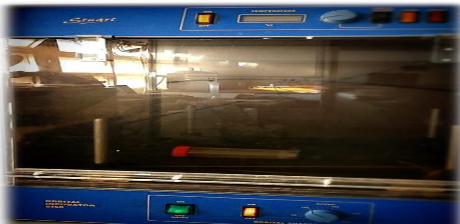
الشكل (13) يبين حضانة الهزازة يستخدم لنمو الأحياء المجهرية في درجات حرارة محددة وتوفير التهوية الجيدة لها
