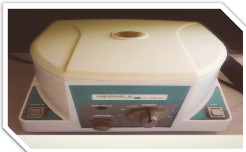
شكل (8) يوضح جهاز الطرد المركزي الذي يستعمل لفصل المواد
